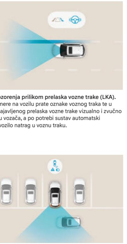
Sustav upozorenja prilikom prelaska vozne trake (LKA). Prednje kamere na vozilu prate oznake vozne trake te u slučaju nenajavljenog prelaska vozne trake vizualno i zvučno upozoravaju vozača, a po potrebi sustav automatski usmjerava vozilo natrag u voznu traku.
