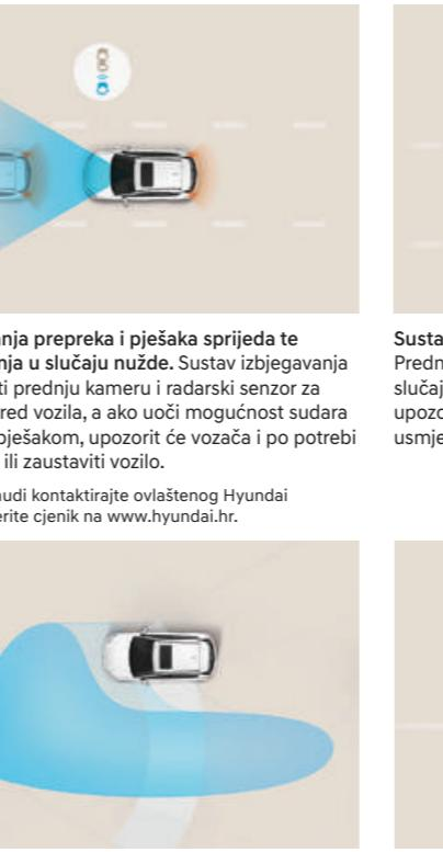
Sustav prepoznavanja prepreka i pješaka sprijeda te autonomog kočenja u slučaju nužde. Sustav izbjegavanja sudara (FCA)\* koristi prednju kameru i radarski senzor za nadzor prometa ispred vozila, a ako uoči mogućnost sudara s vozilom ispred ili pješakom, upozorit će vozača i po potrebi automatski usporiti ili zaustaviti vozilo.
