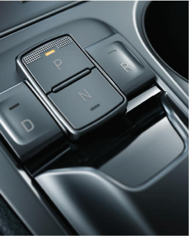
**Tip mjenjača shift-by-wire s tipkama** – Sve što trebate na dohvati ruke, mijenjajte između vožnje unaprijed, praznog hoda, vožnje unatrag i parkiranja, jednostavno pritiskom na tipku koja je praktično smještena unutar središnje konzole. Na istom mjestu možete pronaći i električnu parkirnu kočnicu.
