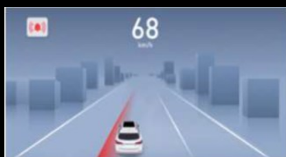
LDW Sustav upozorenja o napuštanju trake ELK Sustav održavanja vozila unutar trake u slučaju nužde LDP Sustav prevencije napuštanja trake
