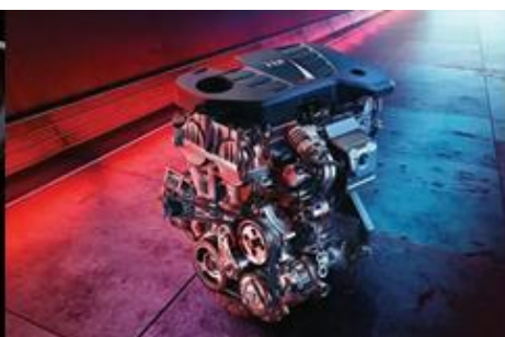
Snažan motor 1.5T GDI s izravnim ubrizgavanjem goriva osigurava snagu od 162 KS
